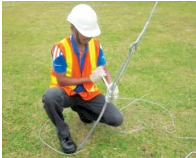
Ujian sampai pada umbang talian atas voltan rendah untuk peperiksaan Penjaga Jentera kategori A1
