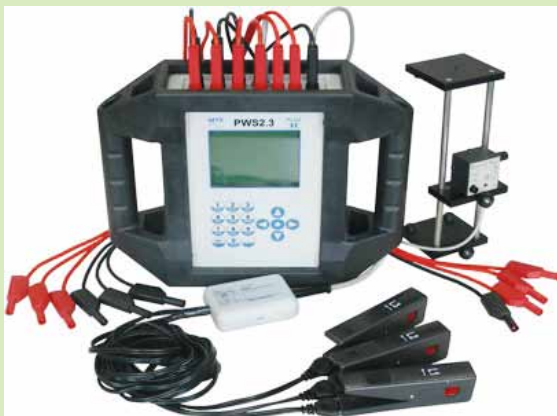
Alat Uji Mudah Alih yang digunakan oleh ST untuk pengujian meter elektrik
