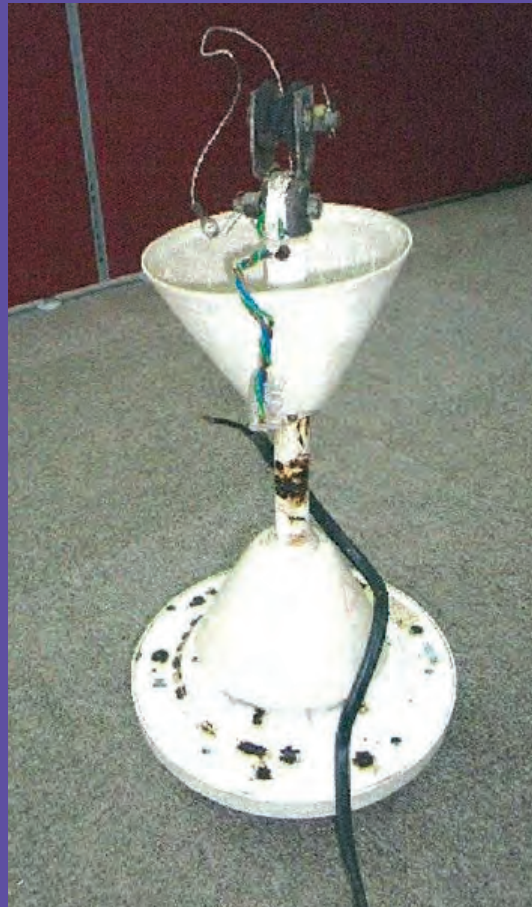
Gambar 3 : Kipas yang disambung dengan kabel mudah lentur, namun didapati sambungannya ke punca bekalan telah tersalah kekutuban.
